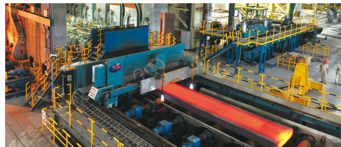
国际首条 ≥ 450 毫米厚直弧型超厚板坯连铸产线
