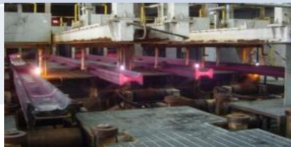
公司研发的首台全国产化异型坯连铸机
