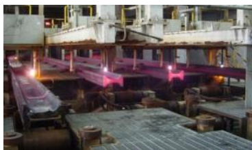
公司研发的首台全国产化异型坯连铸机
